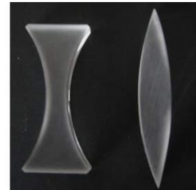
A la izquierda, lente divergente. A la derecha, convergente.
